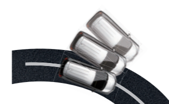
▶ ACTIVE STABILITY CONTROL (ASC) ระบบควบคุมเสถียรภาพการทรงตัวในสภาวะที่รถเสียสมดุล เพื่อป้องกันการลื่นไถลออกนอกเส้นทางเมื่อเข้าโค้งด้วยความเร็วสูง ถนนลื่น หรือหักหลบกะทันหัน
